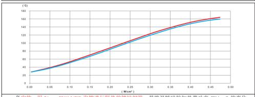
一条<mark>空的、用 20mm PVC-NBR 泡棉进行隔热的镀锌钢管</mark>,其壁温随硅胶加热带功率 (W/cm²) 的变化 而变化。
