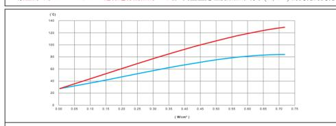
一条用非循环水填充的、不隔热的 PVC 管, 其壁温随硅胶加热带功率 (W/cm²) 的变化而变化。
