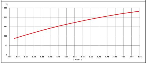
2.5mm 厚的硅胶加热器的表面温度随表面功率负载的变化。这加热器悬挂在环境温度为 25℃的静止的空气中,不是固定在金属表面上。加热器不受温度限制系统所保护。<mark>在这种情况下,加热器在 235℃不可逆转地损坏</mark>。
