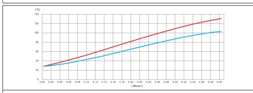
一条用非循环水填充的、用 20mm PVC-NBR 泡棉进行隔热的 PVC 管, 其壁温随硅胶加热带功率 (W/ cm²) 的变化而变化。
