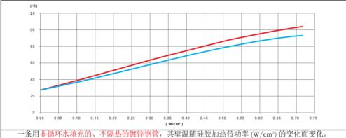
一条用非循环水填充的、 不隔热的镀锌钢管, 其壁温随硅胶加热带功率 (W/cm²) 的变化而变化。
