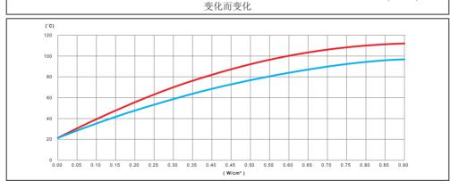
一条用非循环水填充的,不隔热的不锈钢管,其壁温随硅胶加热带功率 (W/cm²) 的变化而变化。
