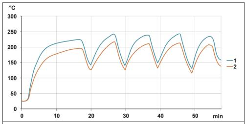
在安装在 55 加仑 (200 升 ) 鼓形桶的 200 毫米宽的硅胶带进行温度测量。功率 2250W(0.75W /cm²),带传感器位于空罐的中间的 PID 控制器。通过碟型温控器将表面温度限制到 190℃。
