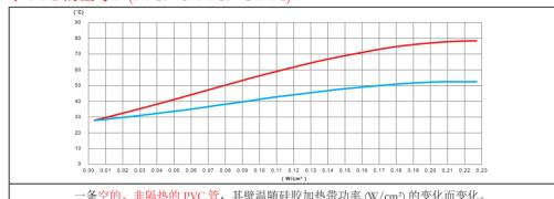
一条空的、非隔热的 PVC 管, 其壁温随硅胶加热带功率 (W/cm²) 的变化而变化。
