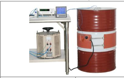
220 升金属鼓形桶的温度随时间的变化,<mark>装满水</mark>,用一块 200mm 宽的硅胶加热带加热,不带保温层, 功率 2250W(表面负荷 0.75W /cm²)。 220 升金属鼓形桶的温度随时间的变化,<mark>装满 HF 24-6 液压油</mark>,用一块 200mm 宽的硅胶加热带加热,不带保温层,功率 2250W( 表面负荷 0.75W / cm²)。
