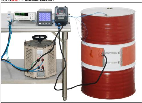
一个 220 升的金属鼓形桶的温度随时间的变化, 填充水,通过一条 200mm 宽的硅胶加热带进行加热,不带保暖层,功率 1500W (表面负载 0.5W/cm²)。
