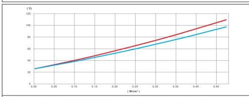
一条用非循环水填充的,用 20mm PVC-NBR 保温棉进行隔热的不锈钢管,其壁温随硅胶加热带功率 (W/cm²) 的变化而变化。
