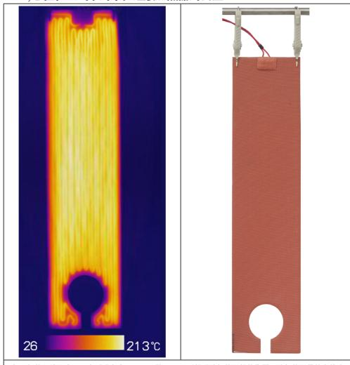
在 25℃的环境温度下,表面功率为 1W /cm² 的 2.4mm 平的硅胶加热器的热像图,该加热器悬挂在静止的空气中,不是固定在板上。表面温度达到 213℃,接近其破坏温度。
