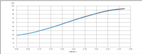
一条用非循环水填充的、用 20mm PVC-NBR 泡棉进行隔热的镀锌钢管, 其壁温随硅胶加热带功率 (W/cm²) 的变化而变化。
