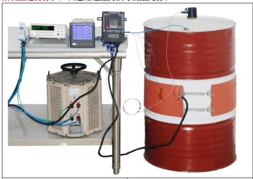
一个 220 升的金属鼓形桶的温度随时间的变化, 填充水, 通过一条 200mm 宽的硅胶加热带进行加 热, 不带保暖层, 功率 2250W (表面负载 0.75W/ cm²)<sub>o</sub>
