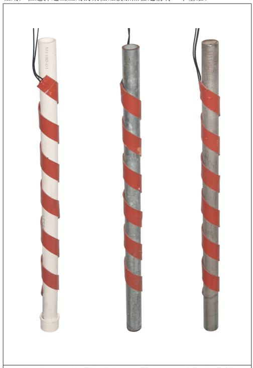
对比性测试的条件: 硅胶加热带缠绕在外径 25mm 的管上,用 PVC-U、镀锌钢和不锈钢制成
